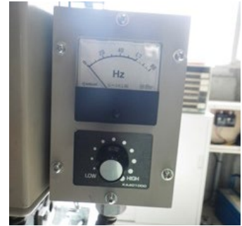
操作側速度調節ダイヤル 最初は0とし，ゆっくりスピードを調整してください。
