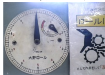
目盛を0に併せて下さい。時々緩むので気を付けて。
