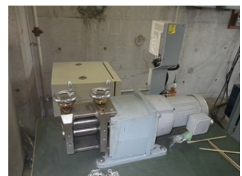
小型溝ロール圧延機(2 台)
