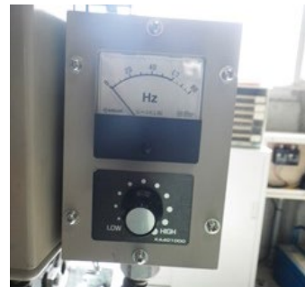
試料挿入側の右手にある速度調整ダイヤル。停止時は、基本的に、ロールが急に動かないように一番左側にしておいてください。
