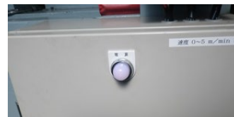
装置本体の電源 ランプが付いていると ON
