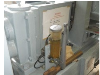
圧延機ロール軸グリス 必要に応じ過度にならないようにグリスして下さい。
