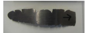
圧延後の試料は耳割れすることが良くあります。手を切らないように。
