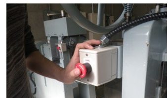
受け手側は、いつでも装置を止められるように準備して置いて下さい。
