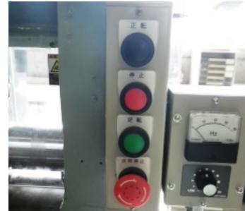
掃除では、ロールは「逆転」で動かして下さい。
