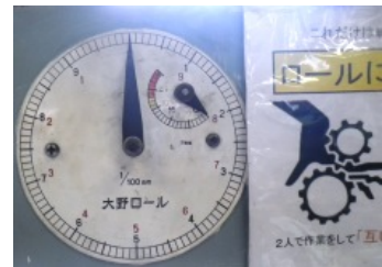
目盛を0に併せて下さい。時々緩むので気をつけて。
