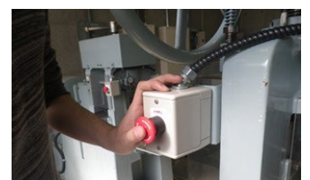
受け手側は、いつでも装置を止められるように準備して下さい。
