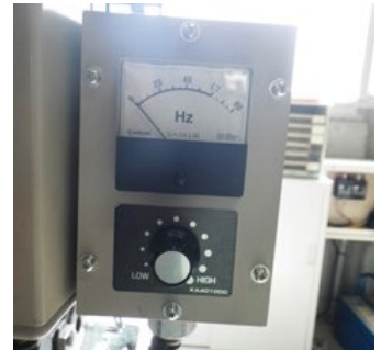
試料挿入側の右手にある速度調整ダイヤル。停止時は、基本的に、ロールが急に動かないように一番左側にしておいてください。
