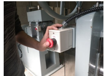
受け手側の一人は、いつでも圧延機を止められるように準備する。導線方向に立たない。
