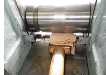
受け手側作業者は、常装置を停止できるように
